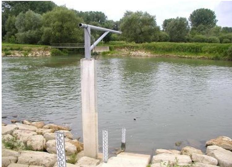
**Figure 3.1 : Station hydrométrique à relation hauteur-débit en section courante, La Meuse à Stenay, 3 904 km<sup>2</sup> (DREAL Grand-Est, UH Meuse Moselle)**
