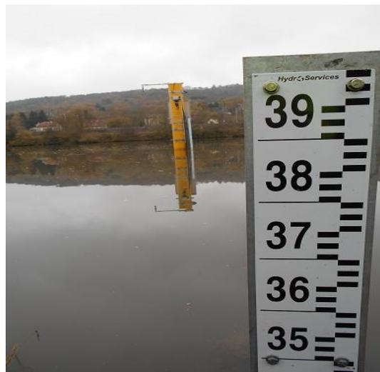
**Figure 3.5 : Station hydrométrique à relation vitesse-débit et mesure par ultrasons et temps de transit, La Moselle à Corny, 7 762 km<sup>2</sup> (DREAL Grand Est, UH Meuse Moselle)**
