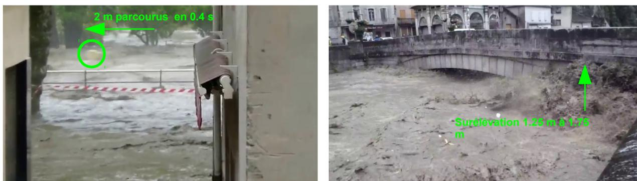
**Figure 7.2 : Exemples d'estimations ponctuelles de vitesse d'écoulement de surface réalisées à partir de vidéos (Ifsttar)**
