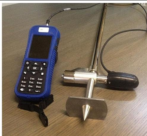
**Figure 4.6 : Un modèle de courantomètre électromagnétique (MF Pro de OTT) : capteur et boîtier**
