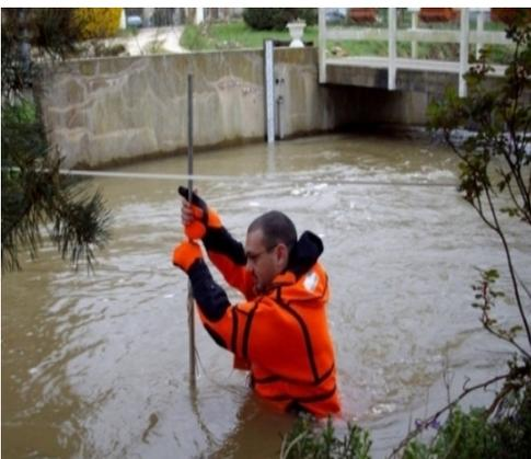
Moyen de mesure inadapté compte tenu du couple hauteur-vitesse.
