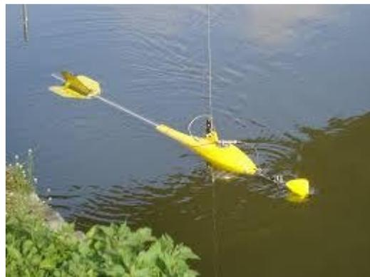
**Figure 4.5 : Montage d'un moulinet sur perche à gauche et sur saumon à droite (DREAL Normandie)**
