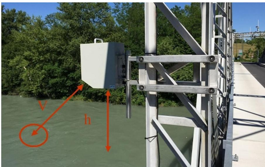
Figure 3.6 : Radar RQ30 – Le Rhône à Pougny, 10320 km<sup>2</sup>(CNR)
