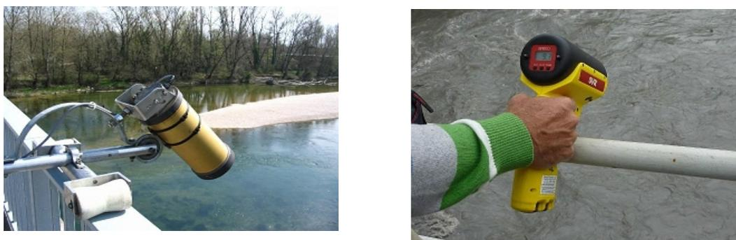
Figure 4.12 : Deux types de radar de surface : le Kalesto (OTT) et le SVR (Decatur) (Irstea)
