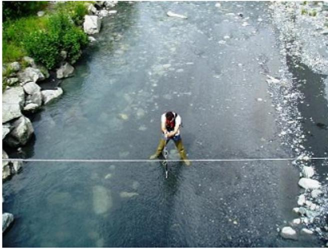
**Figure 4.4 : Jaugeage à la perche – point par point (EDF-DTG)**
